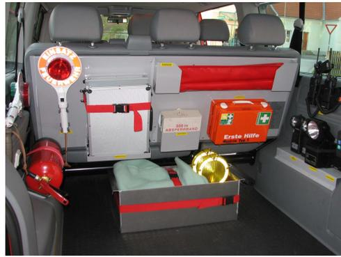
Außer der Normbeladung wurden noch 2 Atemschutzfunkgeräte und 1 Handfunkgerät eingebaut. Zusätzlich ist das Fahrzeug mit einer Standheizung und einem Spannungsregler von 12 V auf 230 V ausgestattet.
